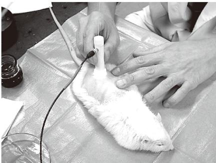
図5 ラット皮膚の光音響波計測状況
